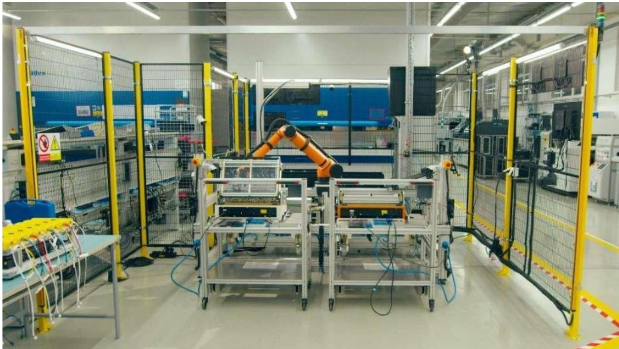
Basierend auf kollaborativen Robotern ermöglicht Test-it-off **Produktwechsel in unter 10 Minuten, NPI in unter 60 Minuten** und bis zu **8 Stunden unbeaufsichtigten Betrieb**. Das
