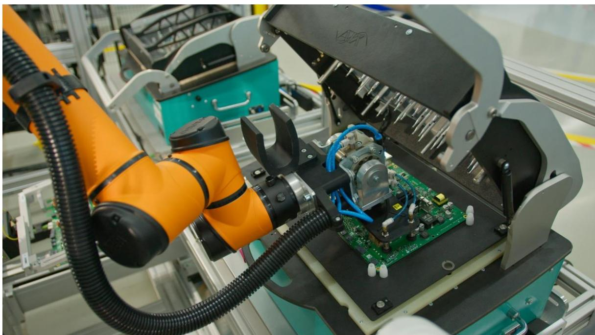
Um diesen Herausforderungen zu begegnen, haben sich **KINALI** und **ATX Hardware GmbH** zusammengeschlossen. Durch die Kombination der **Test-it-off Automatisierungsplattform** von KINALI mit den automatischen Öffnungs- und Schließtechnologien **AOC E/P** von ATX entsteht eine automatisierte PCBA-Testlösung der nächsten Generation. Ihre integrierte Lösung folgt den Prinzipien von **Industrie 4.0** und bringt Hersteller einer vollautomatisierten, **Dark-Factory-fähigen Produktion** näher.
