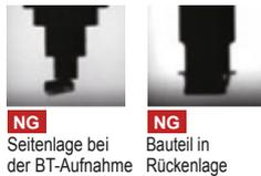
Der Koplanaritäts-Prüfer erkennt deformierte QFP-Anschlüsse vor der Bestückung und verhindert so Fehler bereits im Vorfeld.
